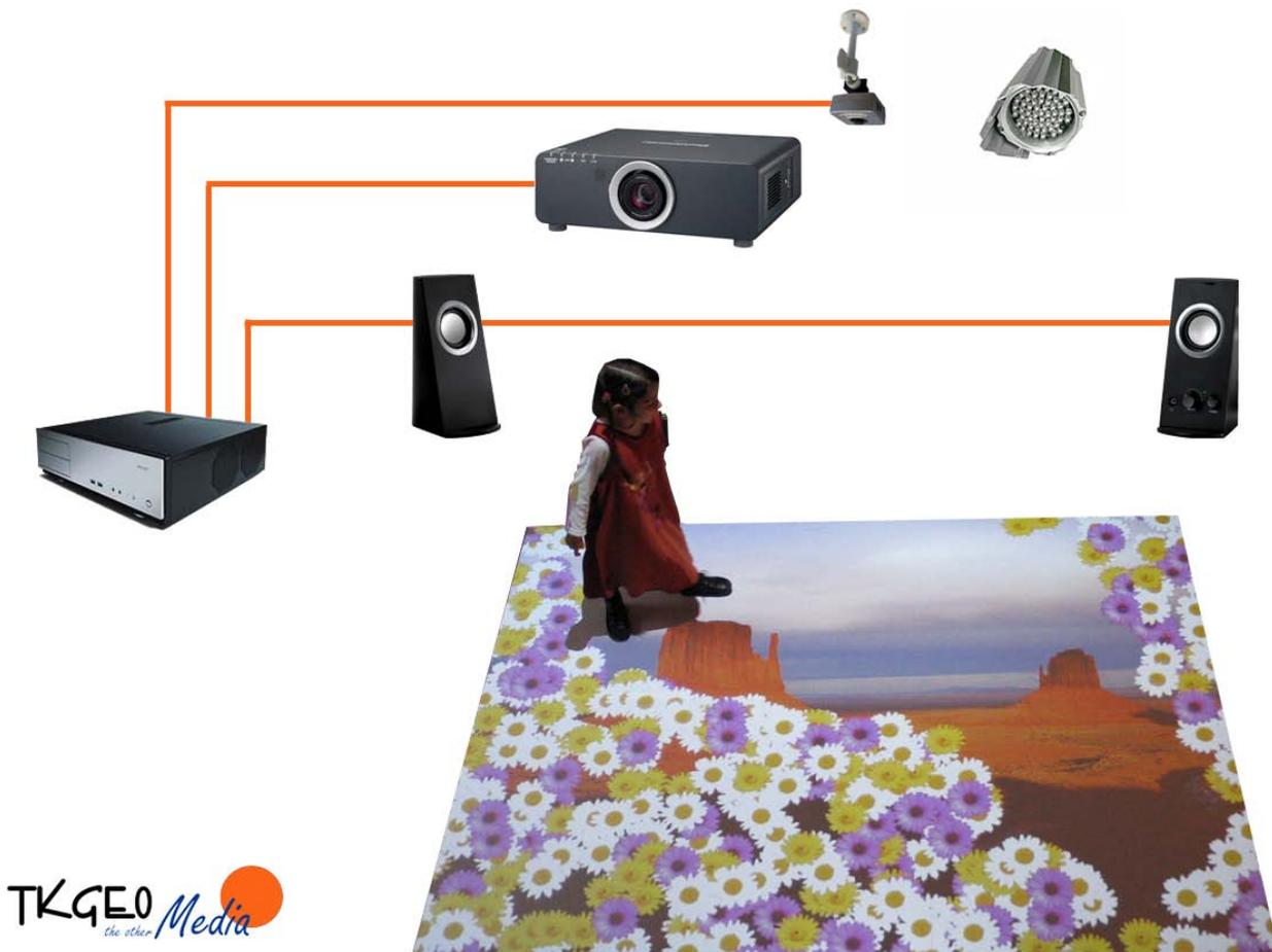
Le sujet éclairé par le projecteur infrarouge est détecté par la caméra qui envoie la position à l'ordinateur et fait ainsi interagir la projection vidéo interactive et le son.
